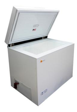
Este nevera/congelador horizontal es muy eficiente y funciona directamente con un solo panel solar. Gracias a las paredes de tres pulgadas de espesor, el baúl se mantiene frío durante la noche, cuando el compresor no funciona. La masa térmica de los alimentos es en sí la "batería" que mantiene fría la unidad.
