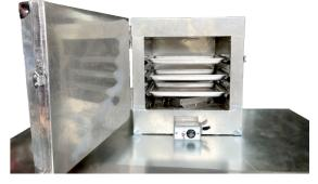
Un horno solar directa energizada por 3-6 paneles fotovoltaicos. Comparte un suministro solar con otros sistemas de 90 VDC, como la bomba de agua. Construcción robusta de chapa metálica con paredes aisladas que mantienen las temperaturas de cocción aun cuando cambian las condiciones solares. Se puede usar como olla de cocción lenta en días nublados.
